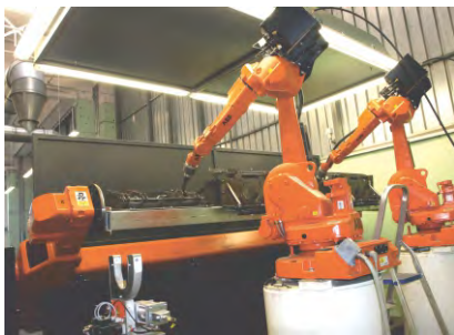
Автоматическая сварочная машина для производства решёток
