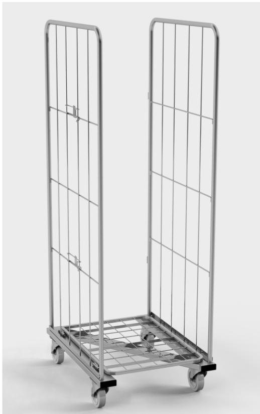
**Технические данные:** стабильная трубная конструкция, боковые сетки изготовлены из стальной проволоки, контейнер оборудован колесами (2 колеса неповоротные, 2 колеса поворотные). Нижняя полка имеет усиления из стальной полосы. Конструкция контейнера позволяет складывать контейнер для парковки.
