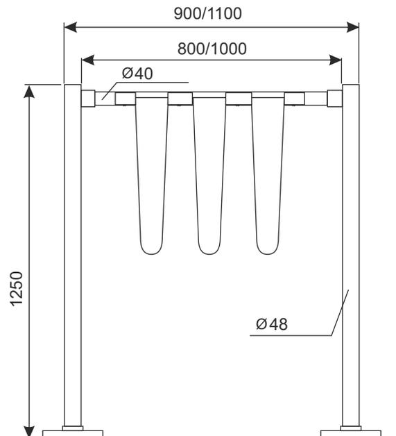
Переезд для тележек является собой соединитель из трубы  $\varnothing 40$  L 800-2000 мм и пластмассовых элементов светло-серого цвета прикрепленных к соединителю.
