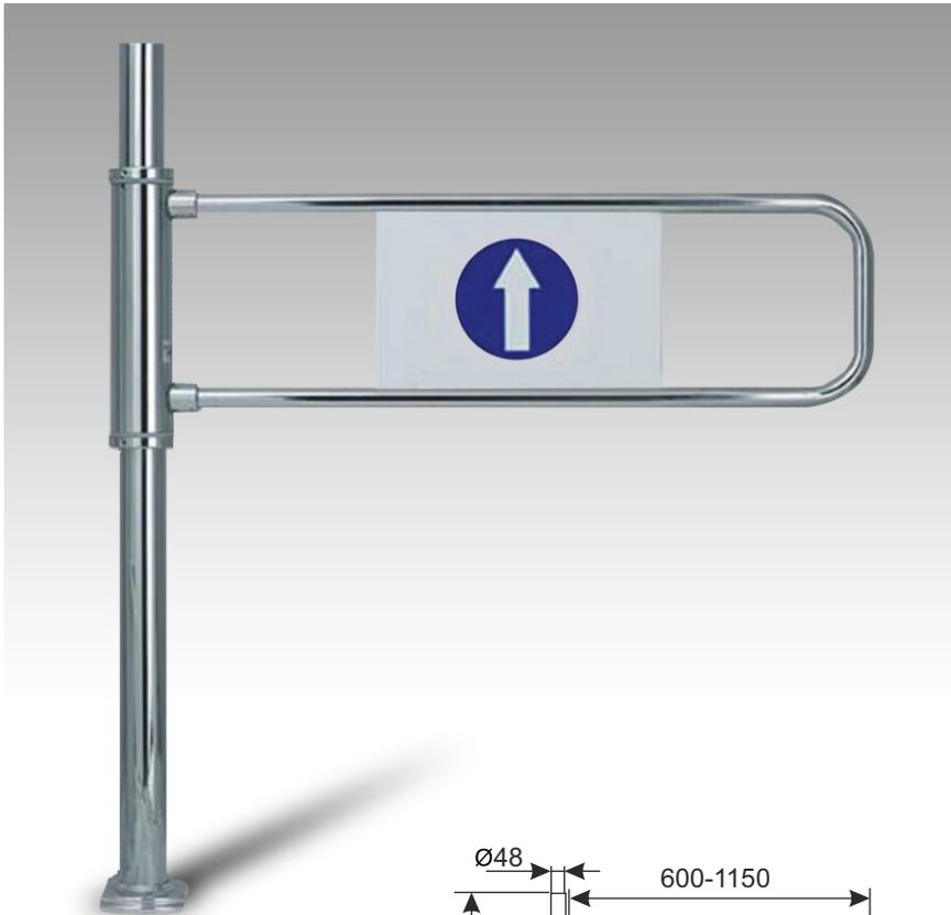
Abhängig von der Art der montierten Sprungfeder kann die Eingangsanlage recht oder links sein. Die Eröffnung des Tores erfolgt durch Drücken der Türbügel in Eingangsrichtung. Der Türbügel schwenkt automatisch in die Ausgangsposition zurück.
