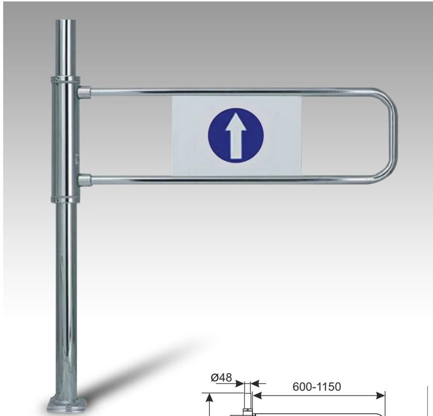
Калитка, в зависимости от вида вмонтированной пружины, может быть правой либо левой открытие в правую либо в левую сторону. Открытие калитки наступает в момент нажатия рукой на крыло калитки в направлении открытия калитки. Закрытие калитки наступает автоматически. Закрытие калитки наступает автоматически.
