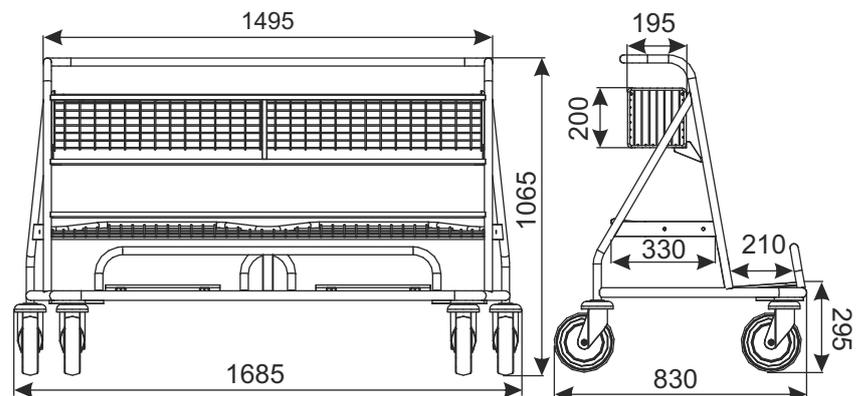
Тележка предназначена для транспортировки гипсокартонных и мебельных плит, фанеры, дверей и т. п. высотой не превышающих 1250 мм.
