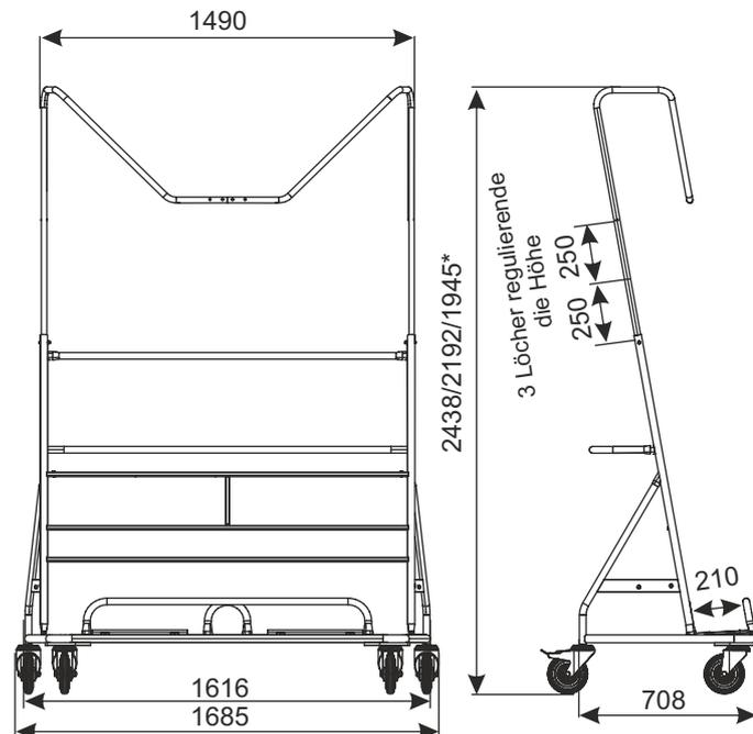
\* 2438 mm – I Regulierungseben (Griff/Bügel an der unteren Bohrung befestigt)
