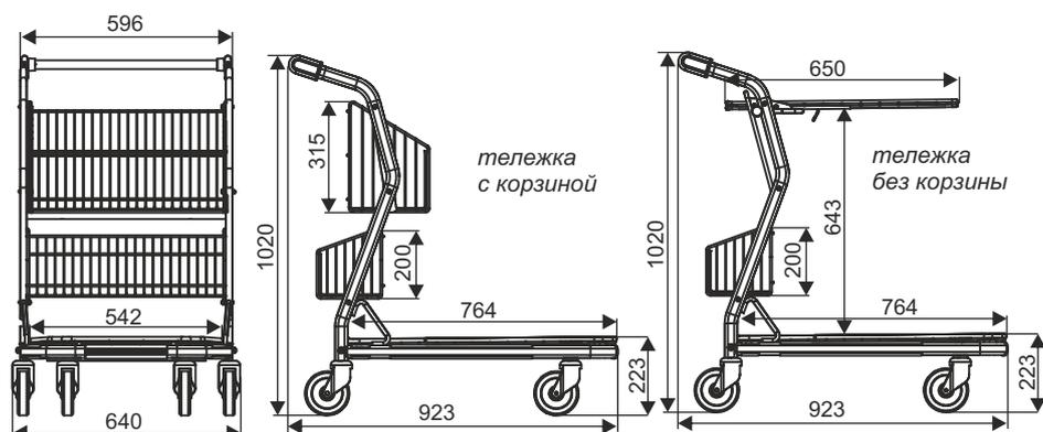
В стандартную комплектацию тележки входит рама на колесах с проволочной платформой. Тележка может быть в различных конфигурациях дополнительного оборудования.
